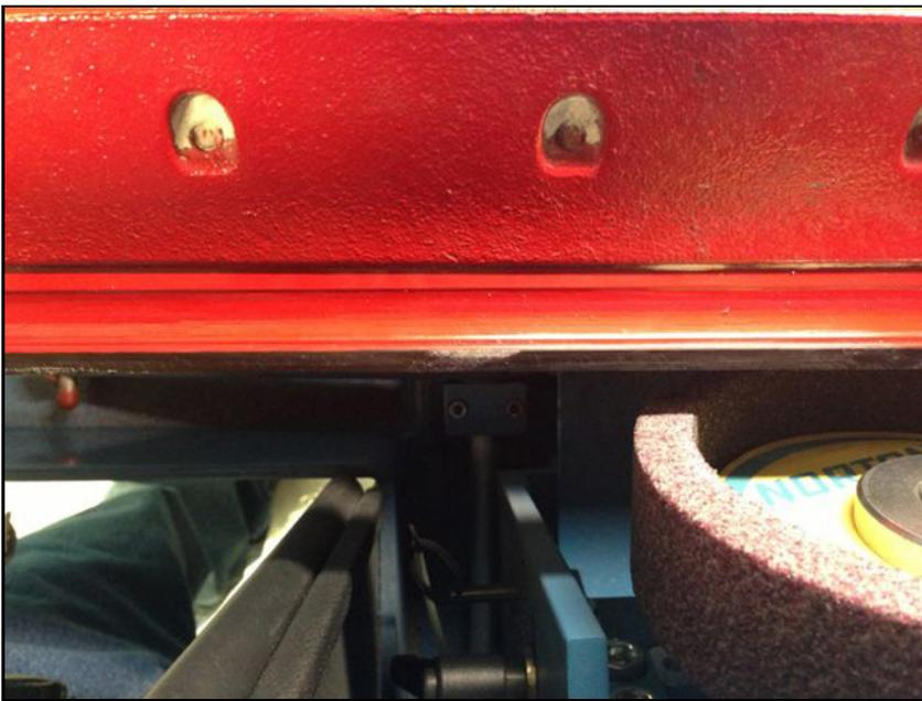
Si usted está amolando una cuchilla usada el rayado debe ser pesado en la parte posterior.
