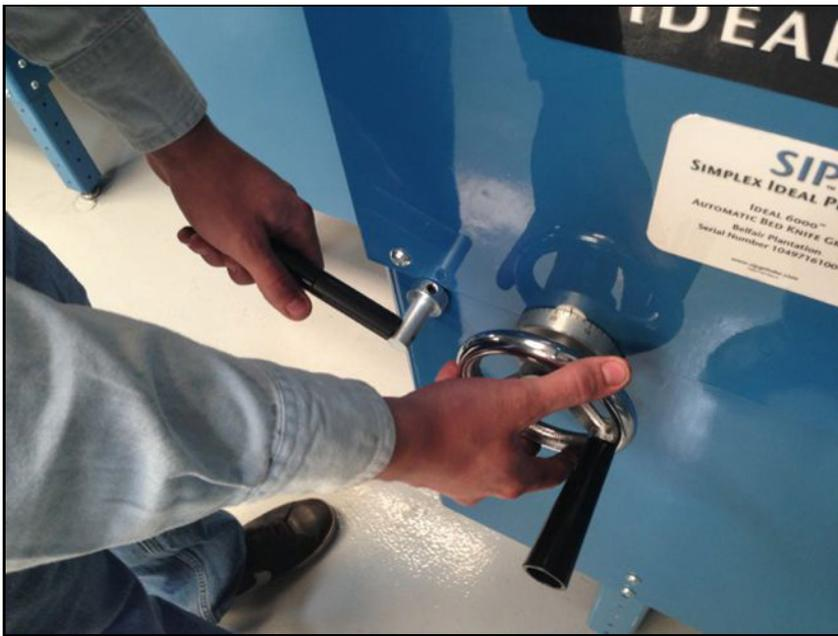
Encienda el motor de la fase frontal, acerque el cabezal de rectificado hacia el diamante y gire el brazo con el diamante hasta que no aparezcan chispas. Apague el motor de la fase frontal.
