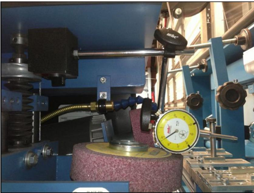
Sujete la base magnética y el indicador a la parte inferior del capó . (Esto viene con la Amoladora Peerless 7000).
