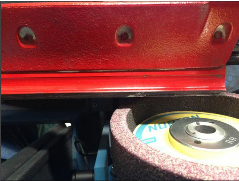
Si el rayado es pesado en la parte frontal de una cuchilla nueva o usada, entonces puede que tenga que ajustar el ángulo para compensar o rectificar la piedra de amolar.
