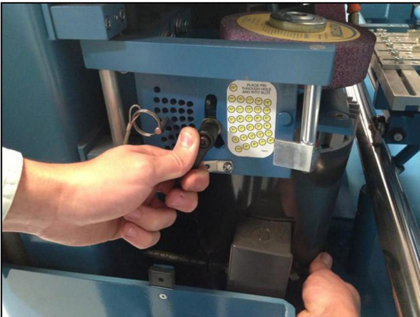
Suelte la abrazadera del cabezal de rectificado.
