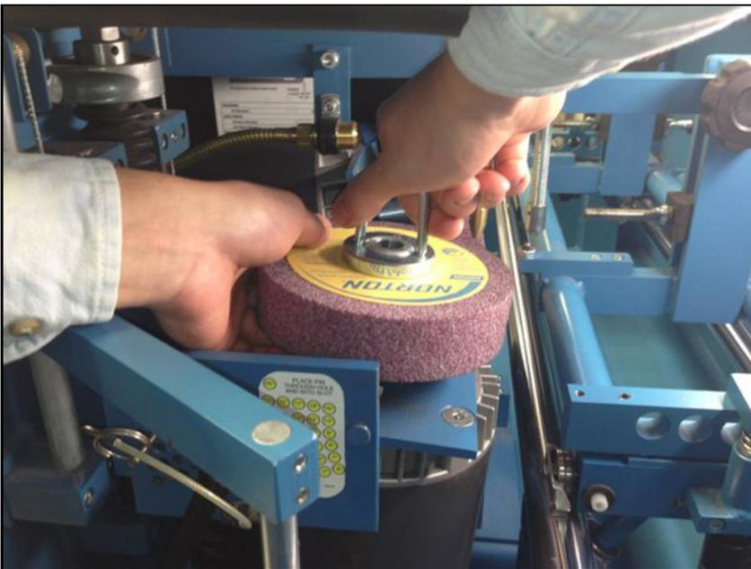
Usando la llave en forma de U provista, sostenga la piedra y desenrosque la tuerca de la rueda. La tuerca de la izquierda se desenrosca girando hacia la derecha. La derecha se gira hacia la izquierda para aflojar.
