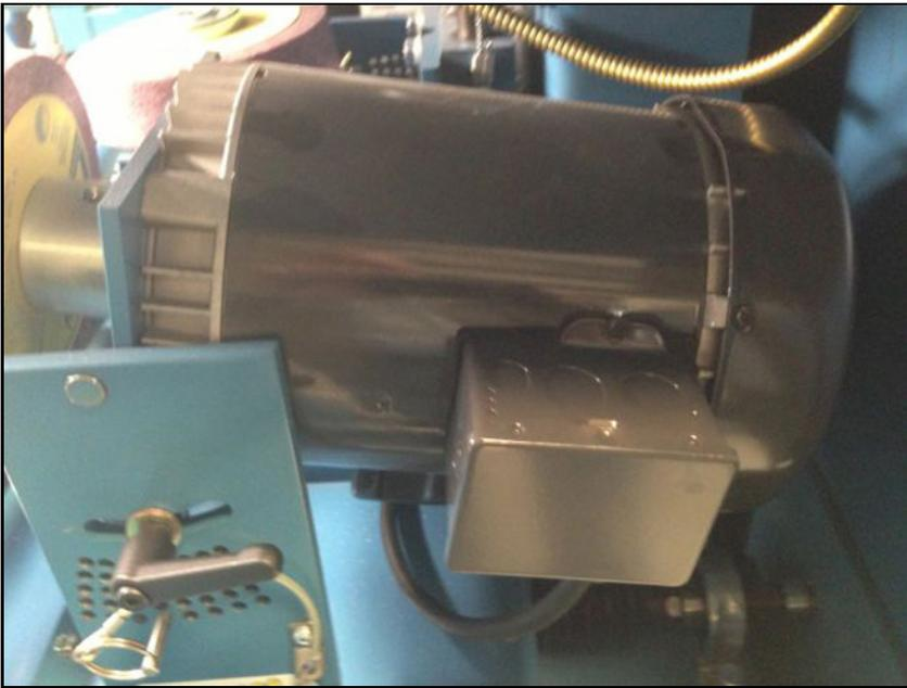
La maquina está equipada con motores con ventiladores de enfriamiento encerrados que no requieren un mantenimiento regular. Los motores deben limpiarse periódicamente, ya sea con una aspiradora o aire comprimido.
