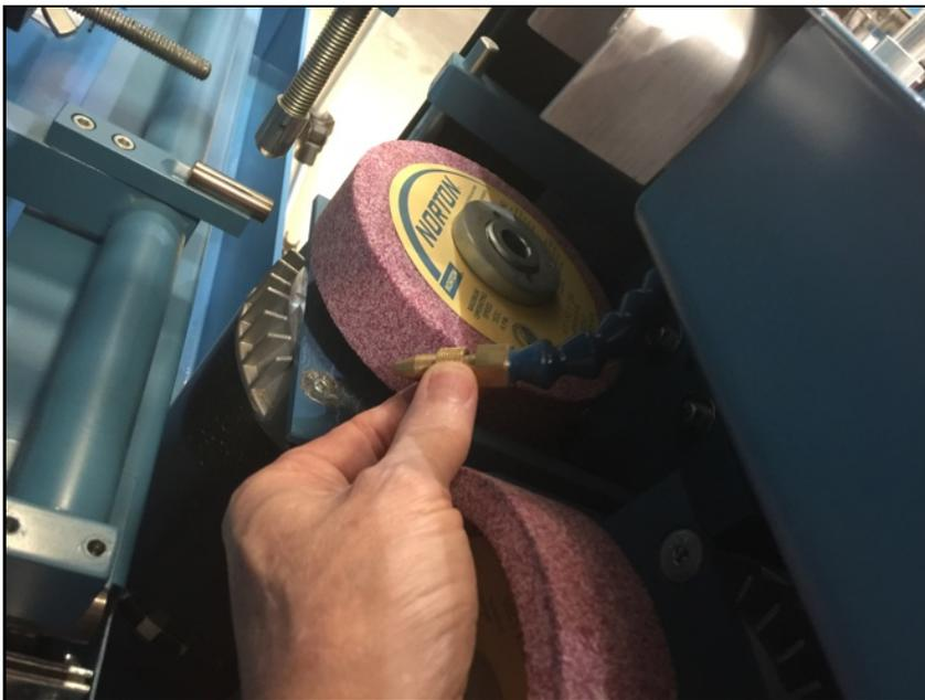
Puede ajustar el flujo de líquido girando la boquilla.
