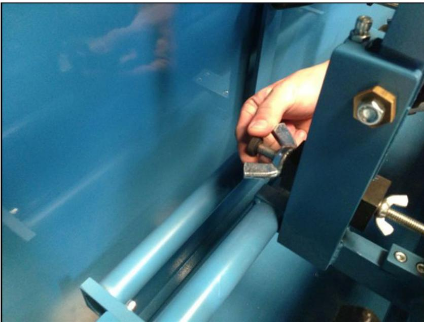
Ajuste el soporte posterior para obtener el borde delantero de la cuchilla cerca de estar parejo. Va a hacer el ajuste final más adelante.
