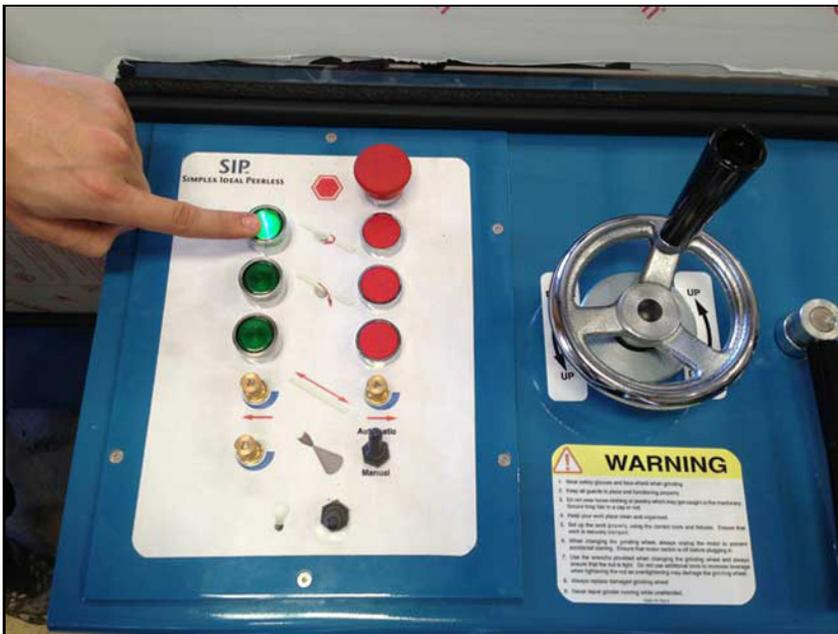
Encienda el motor del cabezal de la fase superior.
