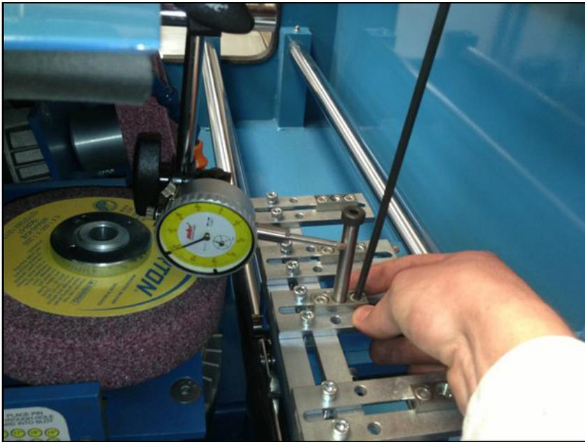
Mueva el carro hacia el pasador de alineación en el otro extremo y vuelva a colocar el pasador del frente hacia atrás hasta que esté en cero. Puede ajustar la posición con sólo apretar ligeramente los tornillos y golpeando ligeramente en la tuerca deslizante para moverla.
