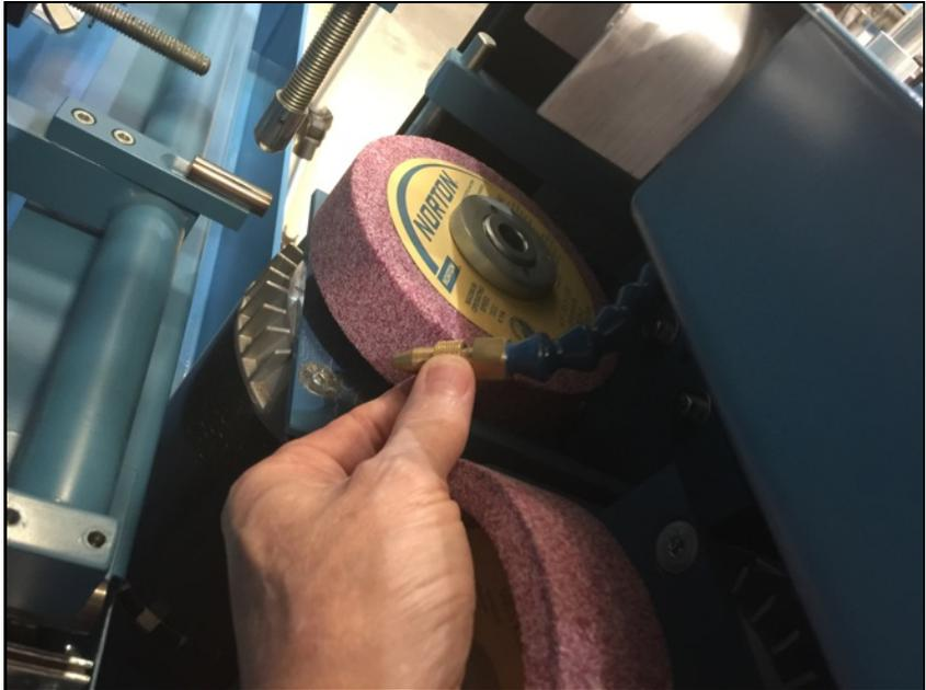
Puede aumentar o disminuir el flujo de refrigerante, puede abrir la puerta, mantener el interruptor momentáneo del refrigerante y ajustar el refrigerante girando la boquilla.
