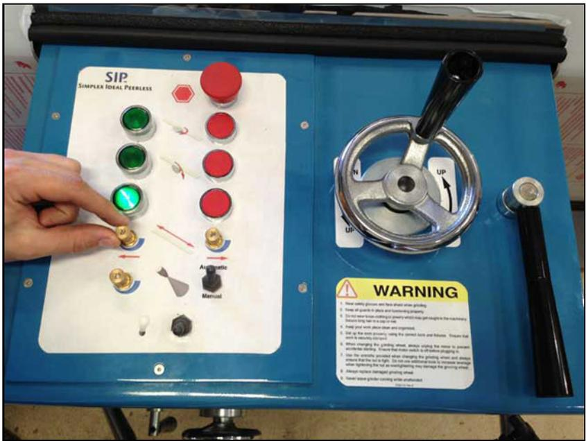
Esto controla la velocidad del carruaje. Esta es una válvula de aguja que permite purgar el aire del cilindro. Girar la manecilla de la válvula de acuerdo al movimiento de las manecillas del reloj (derecha) aumenta la velocidad. Girarla hacia la izquierda disminuye la velocidad.
