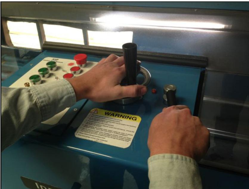
Encienda el motor de la fase superior, a continuación mueva el cabezal y gire el rectificador hasta que no hayan chispas . Apague el motor de la fase superior.
