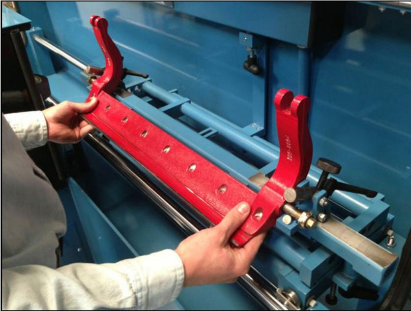
... posícionelos para adaptarse a la cuchilla con sus tornillos de pivote asentados.
