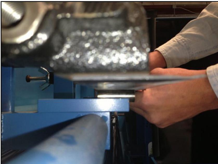
Asegúrese de que el plano inferior de la cuchilla está descansando sobre el eje y la bola y no en ninguna de las cabezas de los tornillos.
