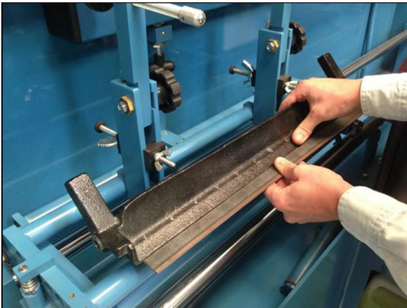
Coloque la cuchilla en los soportes.
