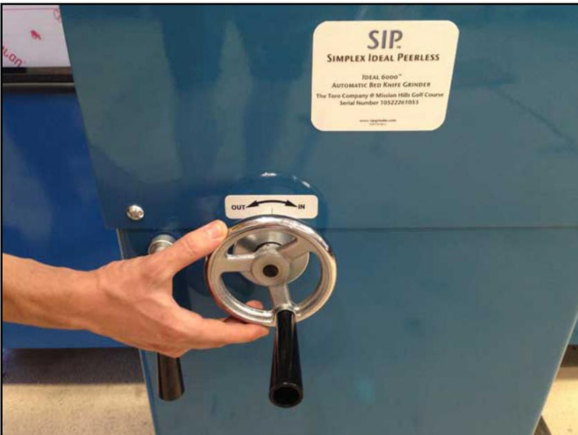
Acerque el cabezal de rectificado hasta que...
