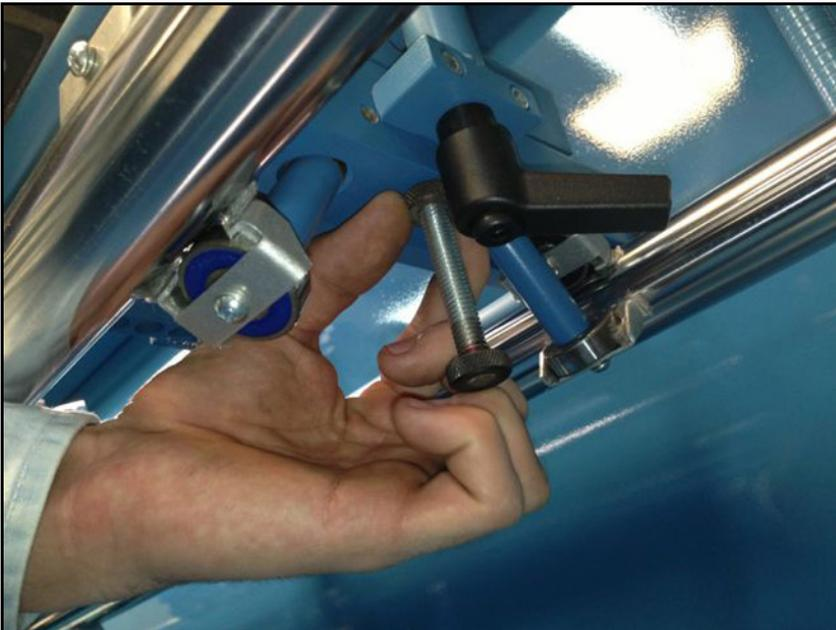
Suelte el tornillo de ajuste vertical.
