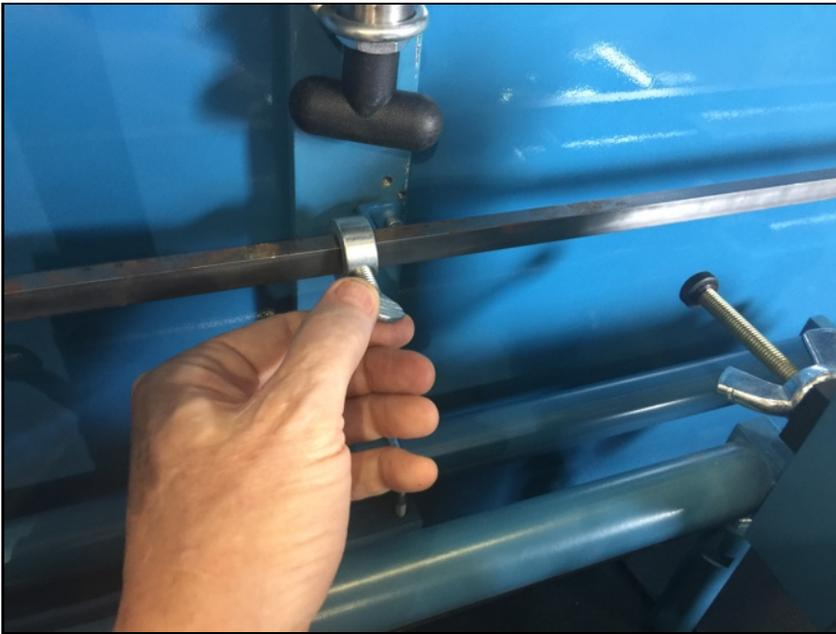
Ajuste el retén del cabezal de rectificado para que ...
