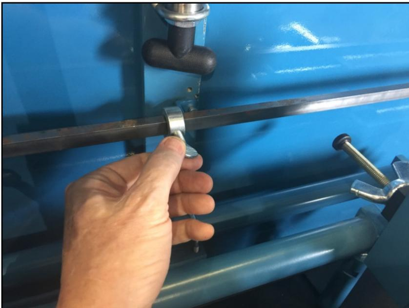
Los retenes de viaje se ajustan aflojando el tornillo de bloqueo, posicionando el retén y apretando el tornillo de bloqueo.
