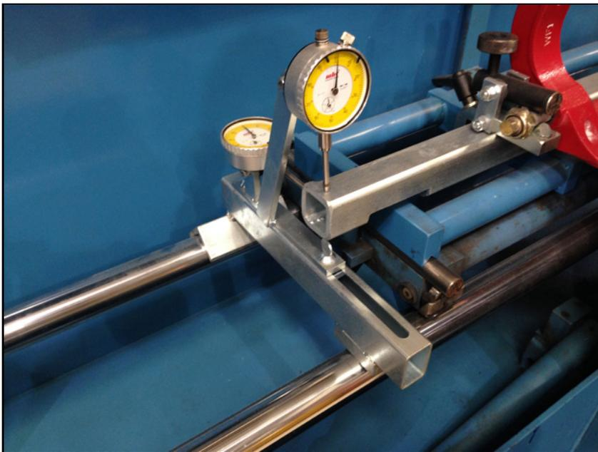
Ajuste el indicador en el extremo izquierdo de la paleta. Ajuste el medidor de manera que ambos indicadores lean cero.
