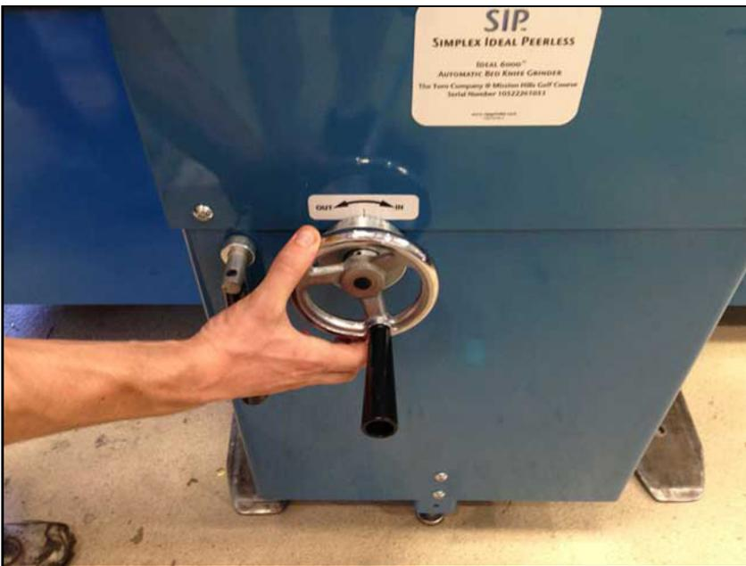
Retroceda el cabezal de rectificado de la fase frontal (derecha), y apague el motor.
